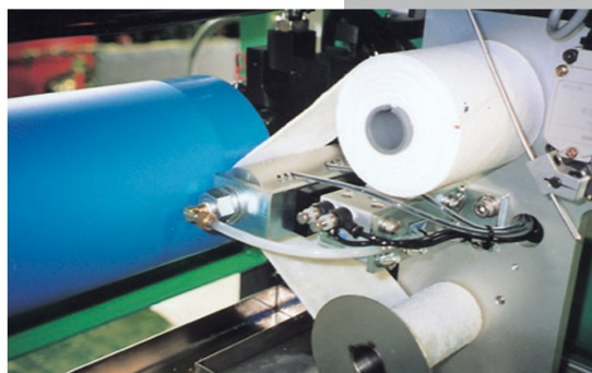
クリーンダッシュローラのクリーニング動作 Cleaning "CLEAN DASH ROLLER"
