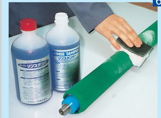
スーパーリンスタンプをかけて、スポンジでリンスする。 Pour Super Rinstamper and rinse by sponge.
